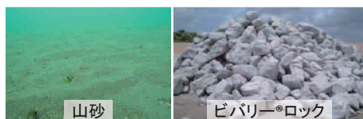
図3 浅場造成に用いた山砂とビバリー ® ロック
